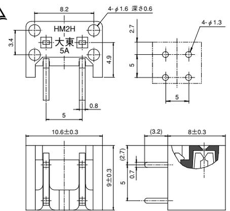
プリント基板実装穴寸法図
