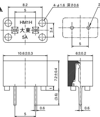
プリント基板実装穴寸法図
