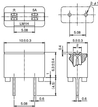
プリント基板実装穴寸法図
