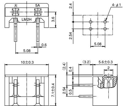
プリント基板実装穴寸法図
