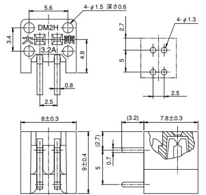
プリント基板実装穴寸法図
