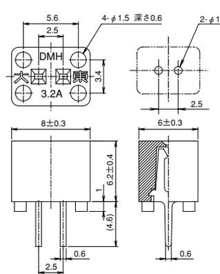
プリント基板実装穴寸法図
